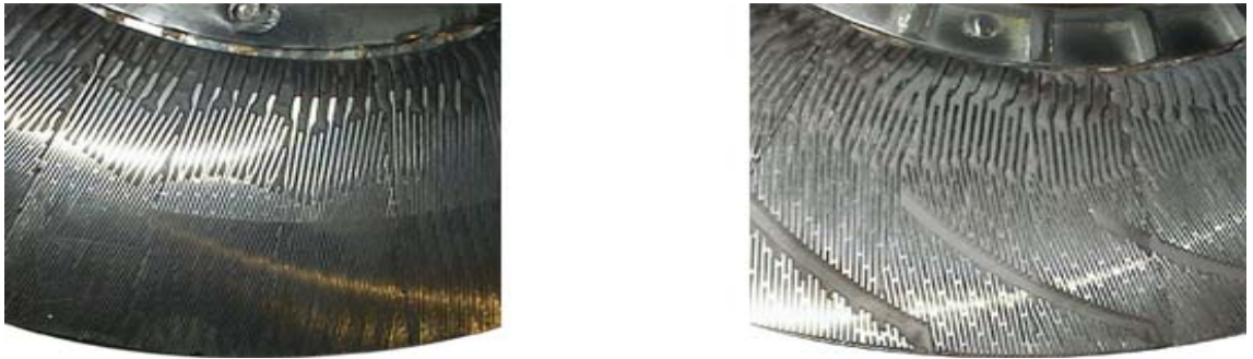
Kuva 9. Vasemmalla puolella staattoripuolen teräsegmenttejä ja oikealla puolella roottoripuolen teräsegmenttejä.
