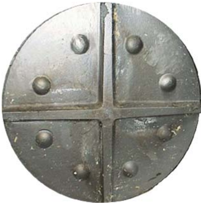
Kuva 11. Kavitaatioilmiö jauhimen roottori-ripuolen keskuslevyn siivekkeissä.
