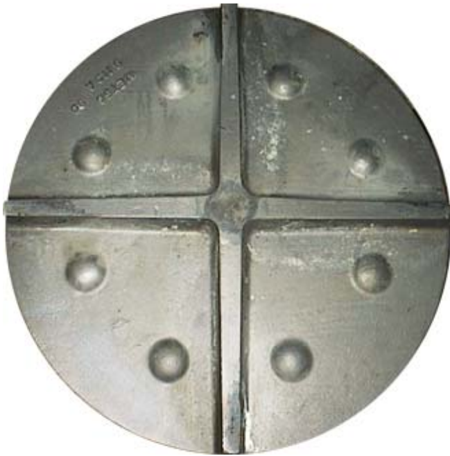
Kuva 13. Siivekkeistä hitsattu ja hiottu jauhimen roottoripuolen keskuslevy.
