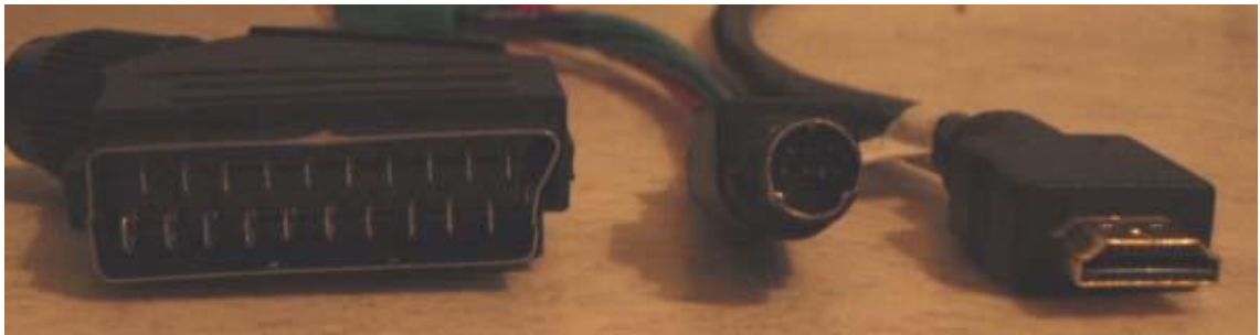
Kuva 2.4 Liittimet vasemmalta SCART, S-Video ja HDMI
