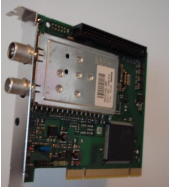
Kuva 4.2 Technotrend Budget C-1500 DVB-C digiviritinkortti kaapeliverkkoon.
