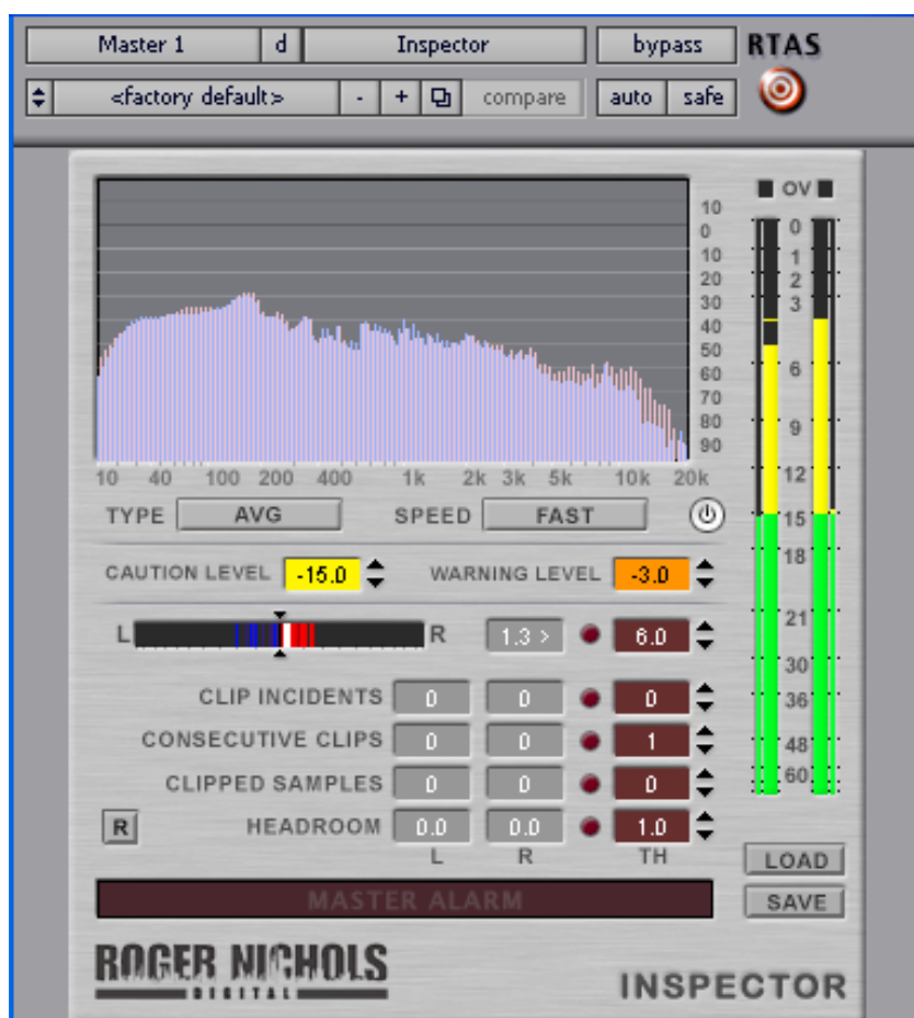
KUVA 4. Roger Nicholisin suunnittelema Inspector -mittari jonka yläosassa spektrianalysointia. Spektrianalysointia vaaka-akselilla kuuloalueen taajuuudet hertseinä ja pystyakselilla äänenvoimakkuus desibeleinä.
