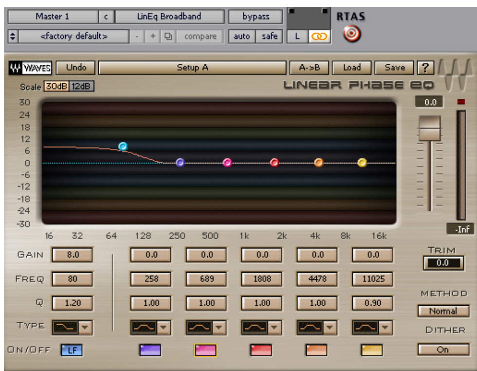
KUVA 9. Vaihelineaarinen ekvalisaattori matalien taajuuksien hyllykorjainasetuksella.
