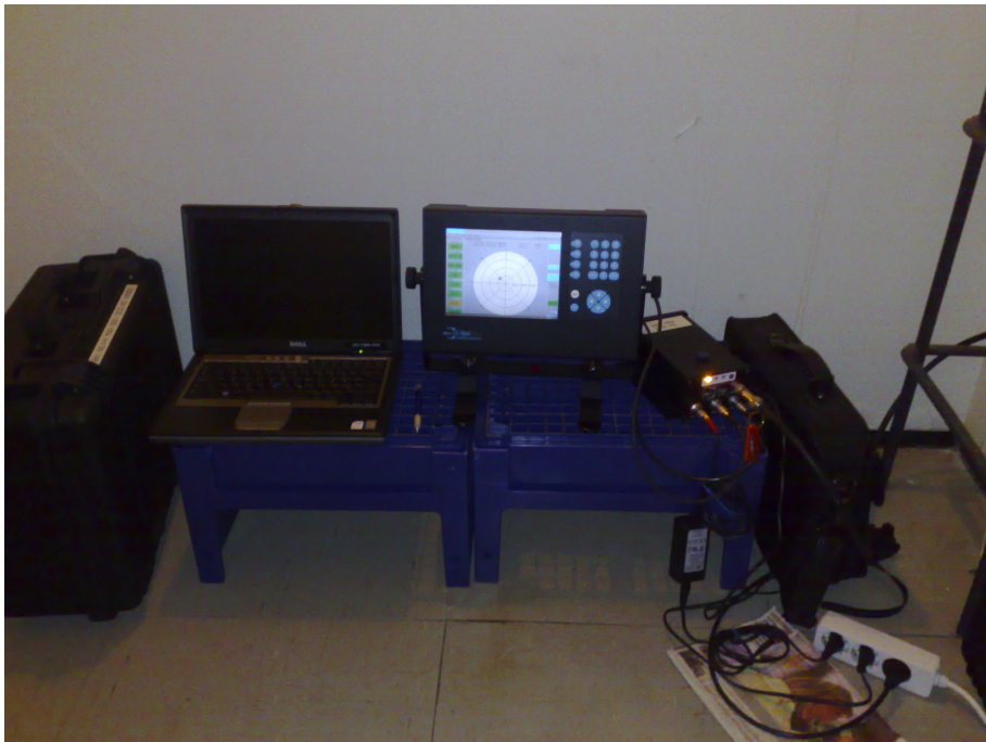
Kuva 15. Testikaluston ”sisälaitteet” Ilmalan vesitornilla, kuvassa vasemmalta lukien: kannettava tietokone, C-NaviGator, C-Nav 2050M ”blackbox”. Kuvan oikeassa laidassa oleva antennijohto vie katolla olevaan antenniin.
