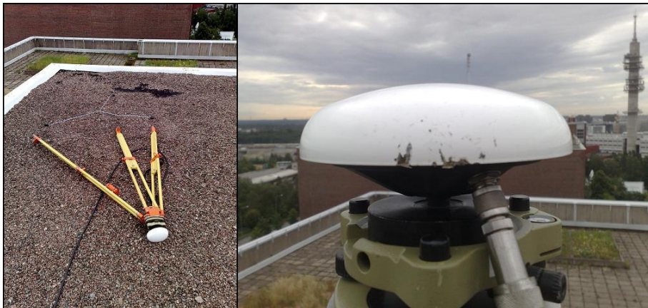
Kuvat 36 ja 37. Kaatunut kolmijalka ja lähikuva vahingoittuneesta antennista.
