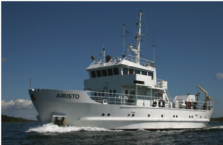
Kuva 41. Monikeilainalus Airisto. Laivan oma GPS-antenni sijaitsee korkeimman maston huipulla, StarFire RTG:tä käyttävä C-Nav-antenni puolestaan sijaitsee komentosillan katon etureunassa näkyvässä mastossa.
