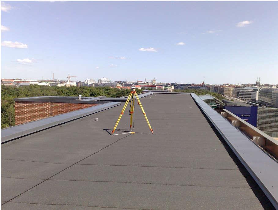
Kuva 16. Testikaluston ”ulkolaitteet”, eli antenni, antennijohto, kolmijalka sekä kolmijalan alusta. Kuvauspaikka Helsinki City West Holiday Inn -hotellin katto.
