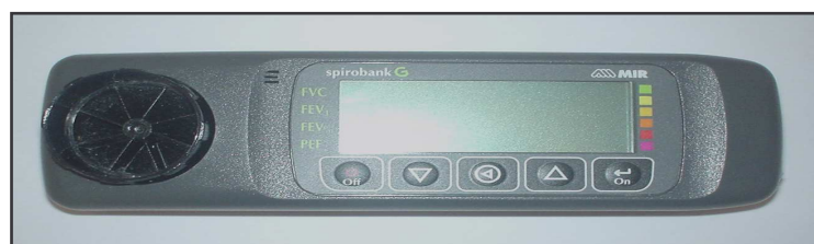
Figura 1 – Equipamento utilizado para realização da espirometria no pré-operatório. Espirômetro portátil – Spirobank G (Mir).
