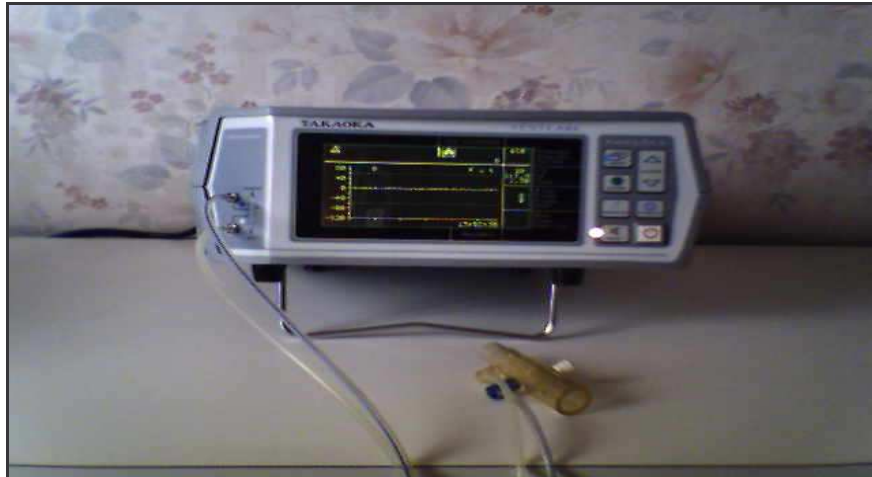
Figura 2 – Equipamento utilizado para avaliação da complacência pulmonar e resistência do sistema respiratório - Ventcare 9505 VSF (Takaoka).
