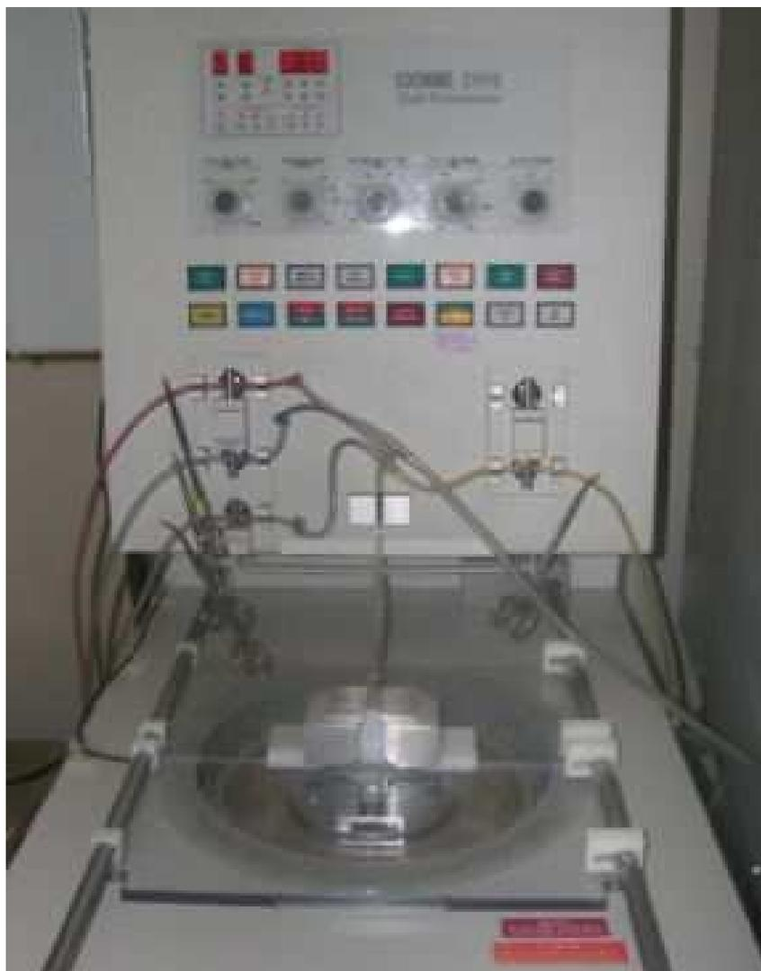
Figura 5 – Processo de centrifugação (COBE 2991) para isolamento das ilhotas pancreáticas.
