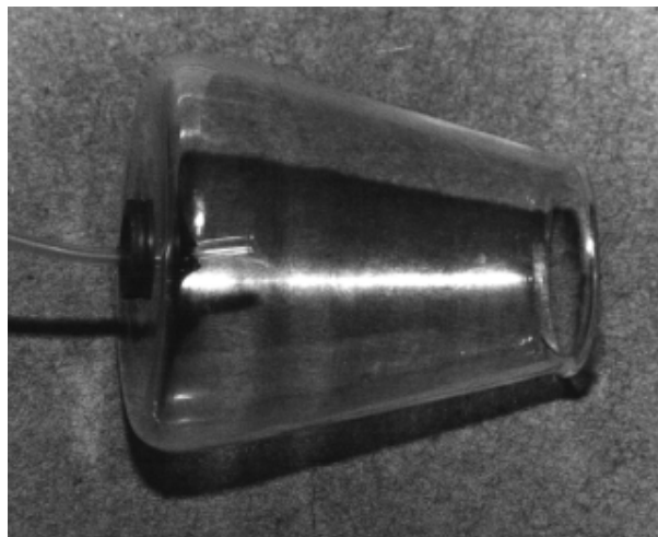
FIGURA 2 - Visão detalhada da câmpanula do vaporizador
