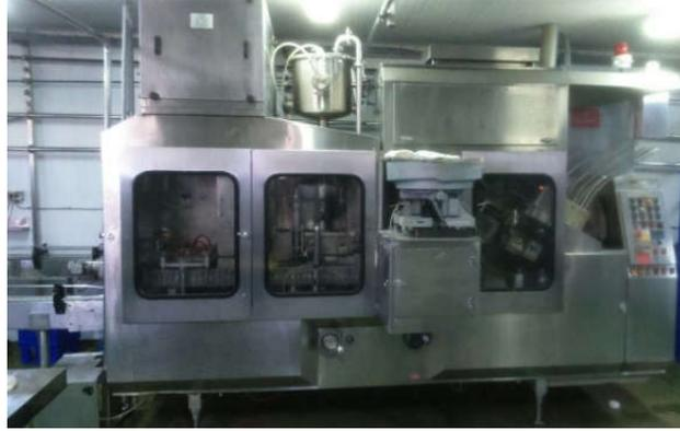
Figura 6.1: Línea de llenado Elopak P-S30D. Fuente: Exapro.
