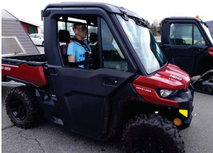
Figure 3.1 Montage du mannequin binaural dans le véhicule.
