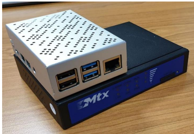
Figura 3.9 Router con Raspberry con API Rest
