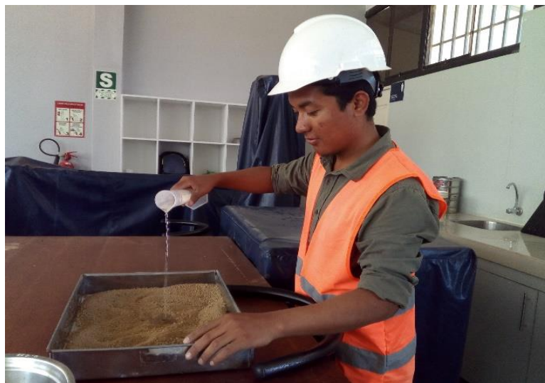
Figura N° 24: Humedecimiento de muestra
