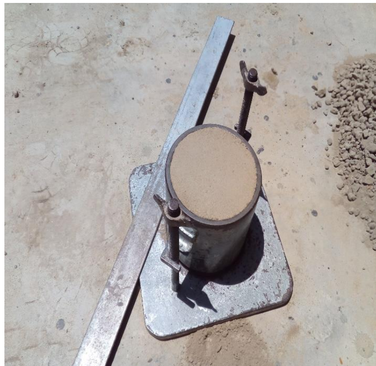
Figura N° 26: Arena compactada + molde
