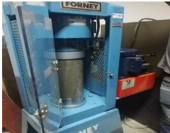
Figura 5. Prueba de resistencia de compresión
