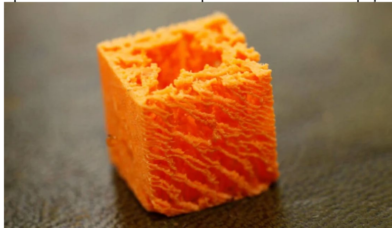
Figura 28 - Efeito Causado por Fluxo Insuficiente de Material [44]
