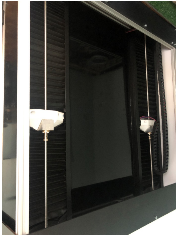
Figura 120 – Montagem chapas de acrílico e foles de proteção
