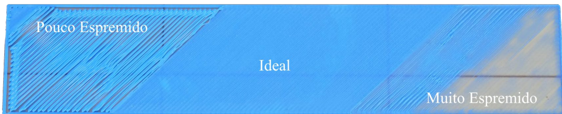
Figura 27 - Efeito da Distância do Bico à Base de Impressão [43]
