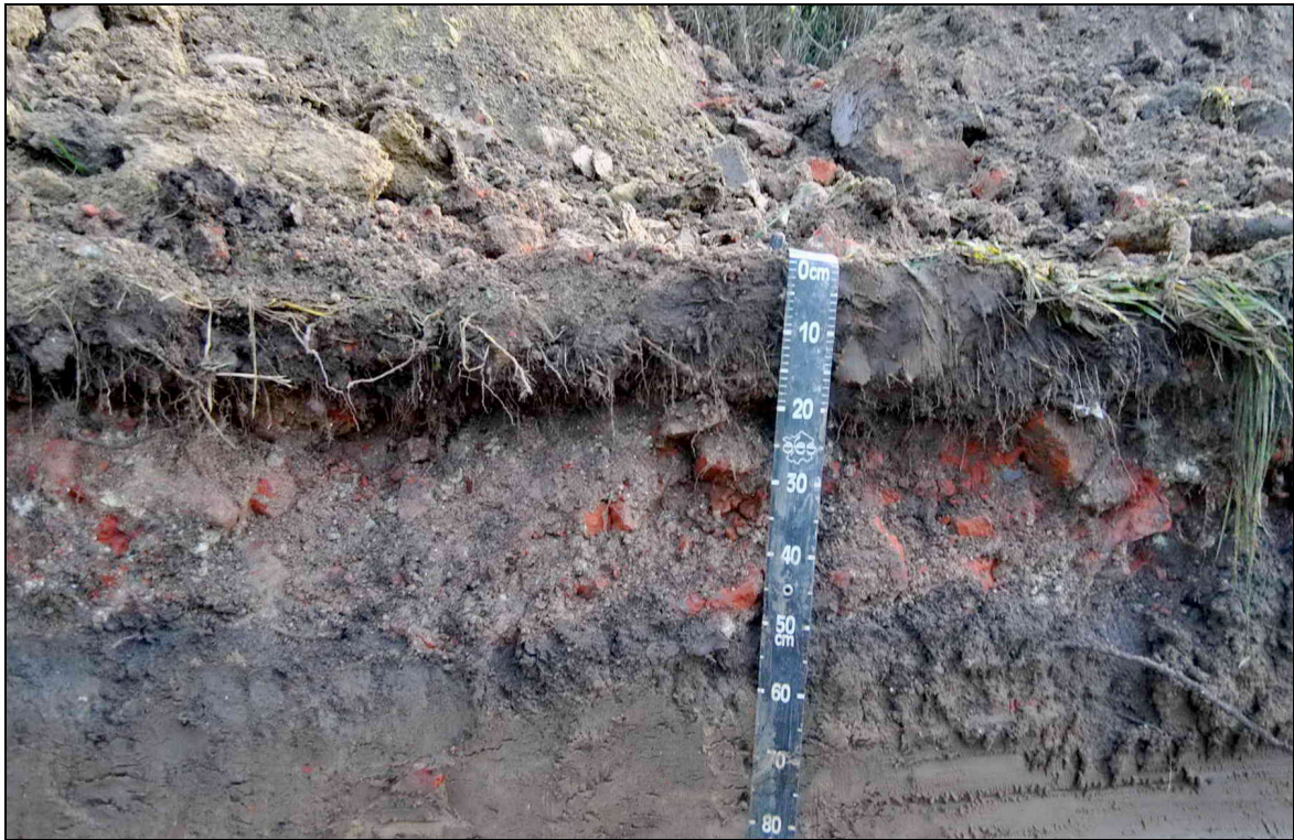
Profiel Hoegaarden-04, Slecht gedraineerde zware leembodem, begraven onder bouwpuin van bakstenen, (bodemtype: OB, WRB-2014: Urbic Technosol (Gleyic))
