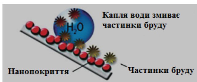
Рис. 1. Принцип самоочищення наночастинками \text{SiO}_2
