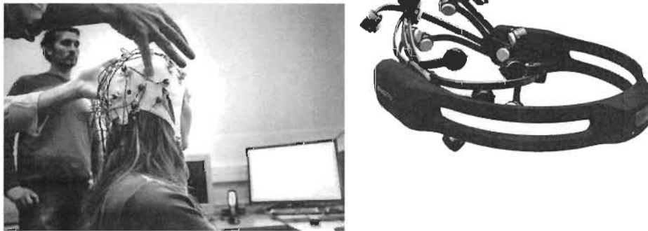
Figure 1 Casque traditionnel avec plusieurs électrodes (à gauche), et à droite un nouveau type de casque à 14 électrodes (Emotiv epoc +) [47]
