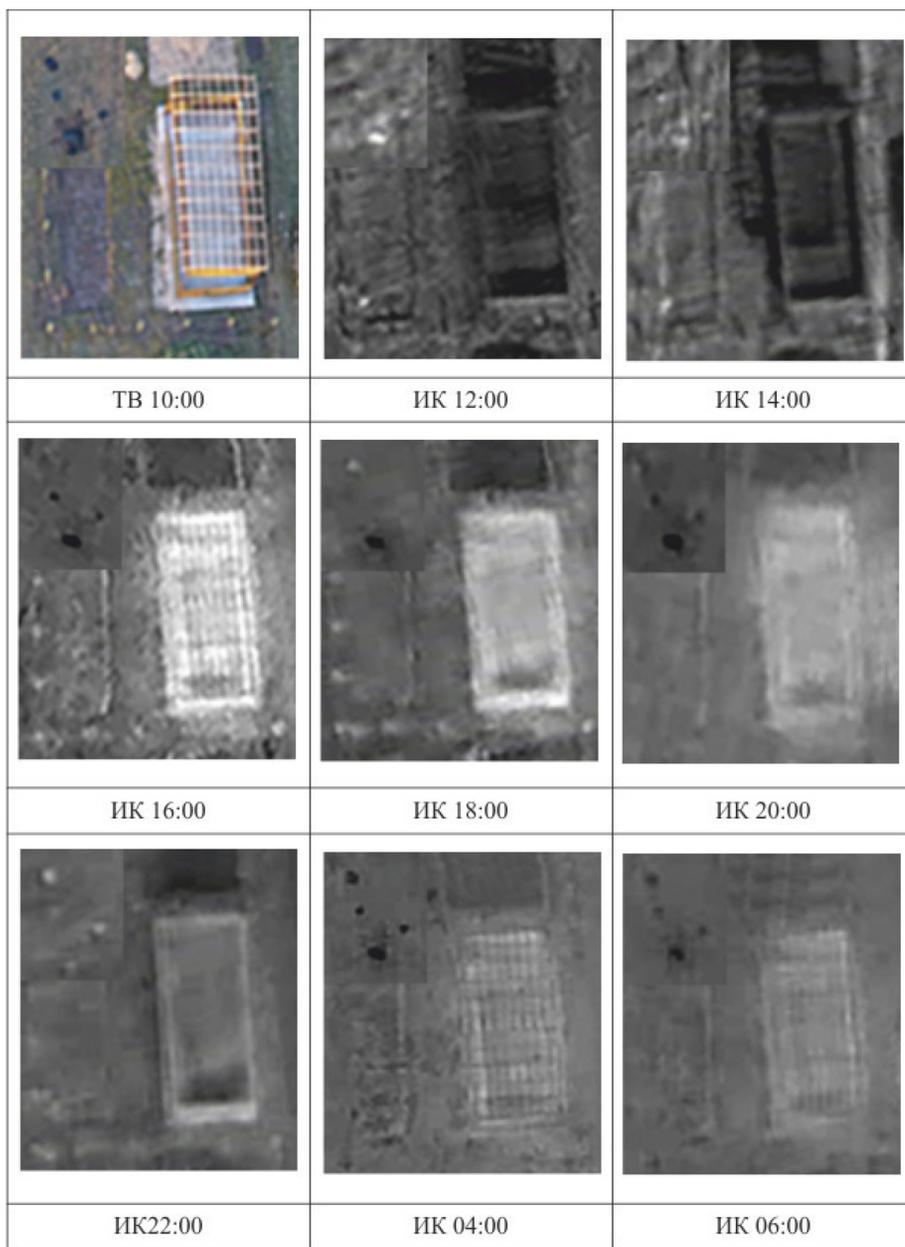
Рис. 1. Разновременные изображения испытуемых материалов в ИК- и видимом диапазонах длин волн
