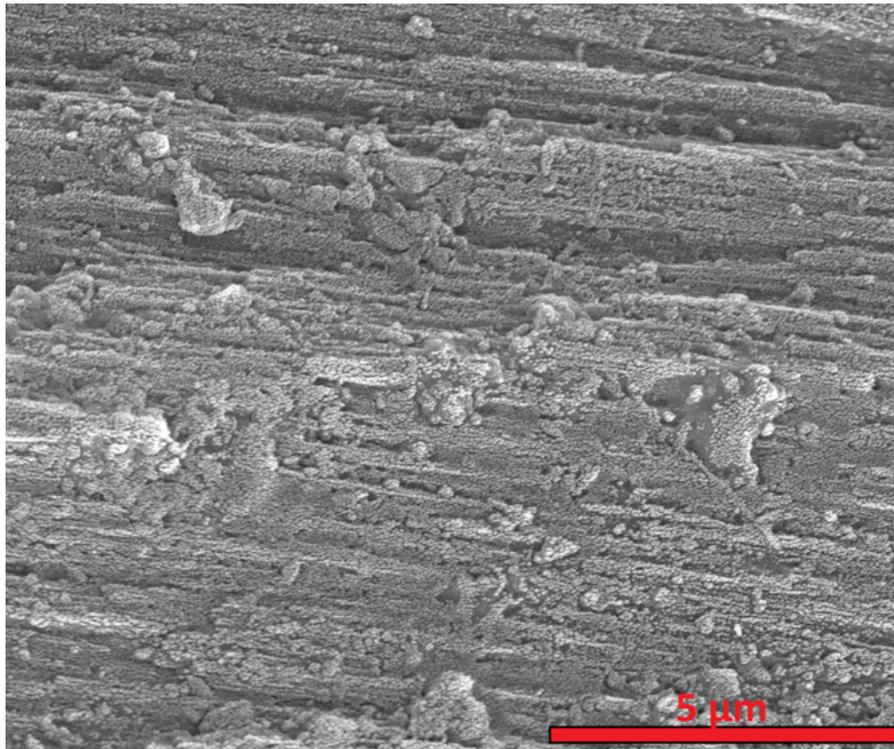
**Fig.4.- MEB. Microesferas de ópalo CT organizadas en fibras. La escala equivale a 5  $\mu$ m. Ver figura en color en la web.**
