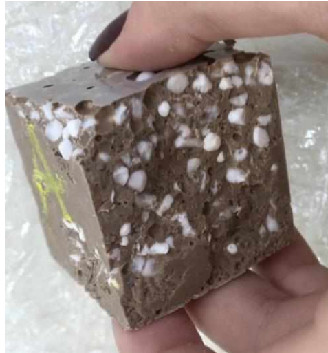
Figura 19: Segregação nos corpos com EPS
