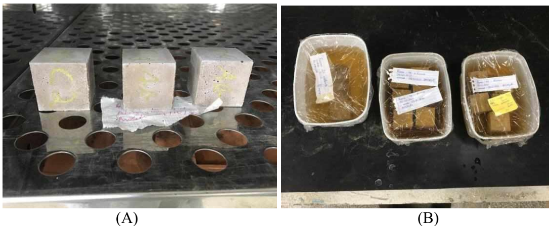
Figura 14: Secagem (A), saturação (B), fervura (C) e determinação da massa em imersão (D)
