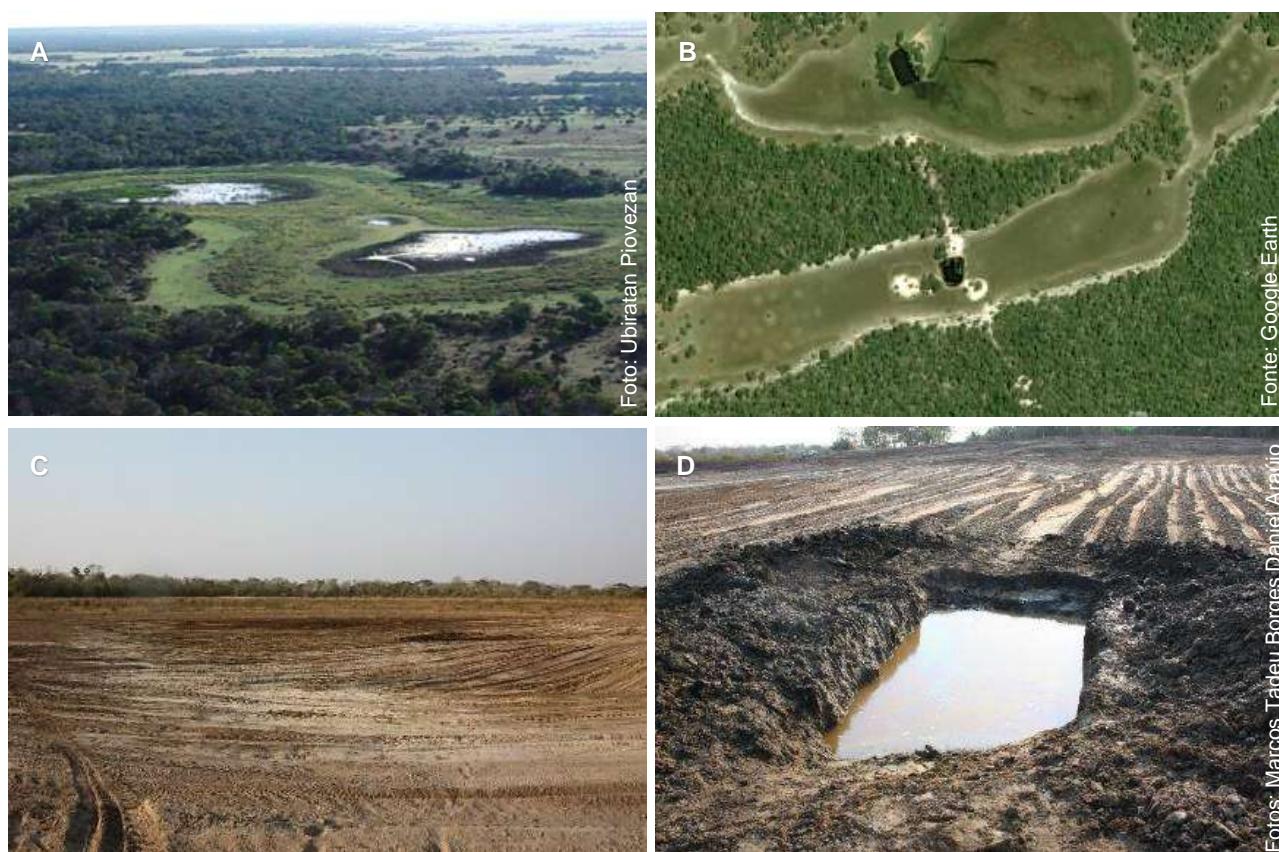
Figura 2. (A) Lagoas sem alterações em ambiente natural; (B) baías aprofundadas em área úmida, vista pela imagem de satélite; (C) área de movimentação durante o aprofundamento de baía na Fazenda Nhumirim, onde a vegetação foi removida em grande área; (D) água do lençol freático acumulada logo após a escavação.
