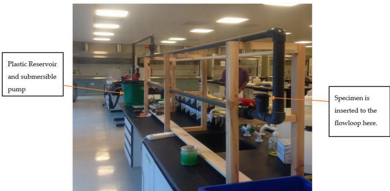
Figure 4. The actual flow loop.
