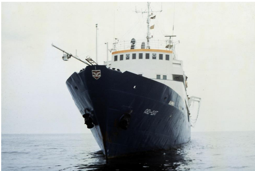
Joon. 7. Uurimislaeva "Aju-Dag", laeva esiosast sirutub aktinomeetriline poom.
