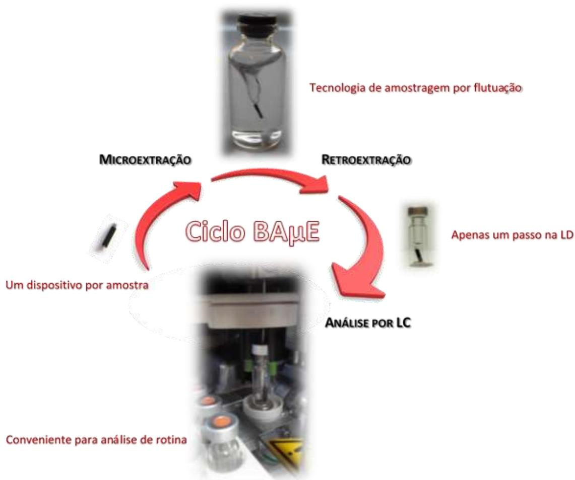
Figura 1.21 – Procedimento analítico proposto para o ciclo ngBA $\mu$ E desde a etapa de microextração até à análise por LC. Adaptado de [65,107].
