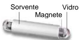
Figura 1.11 – Representação esquemática dos constituintes de um dispositivo usada na SBSE. Adaptado de [76].
