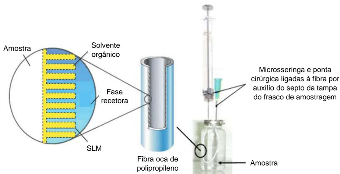
Figura 1.8 – Imagens referentes aos componentes do mecanismo de extração por HF-LPME. Adaptado de [64].
