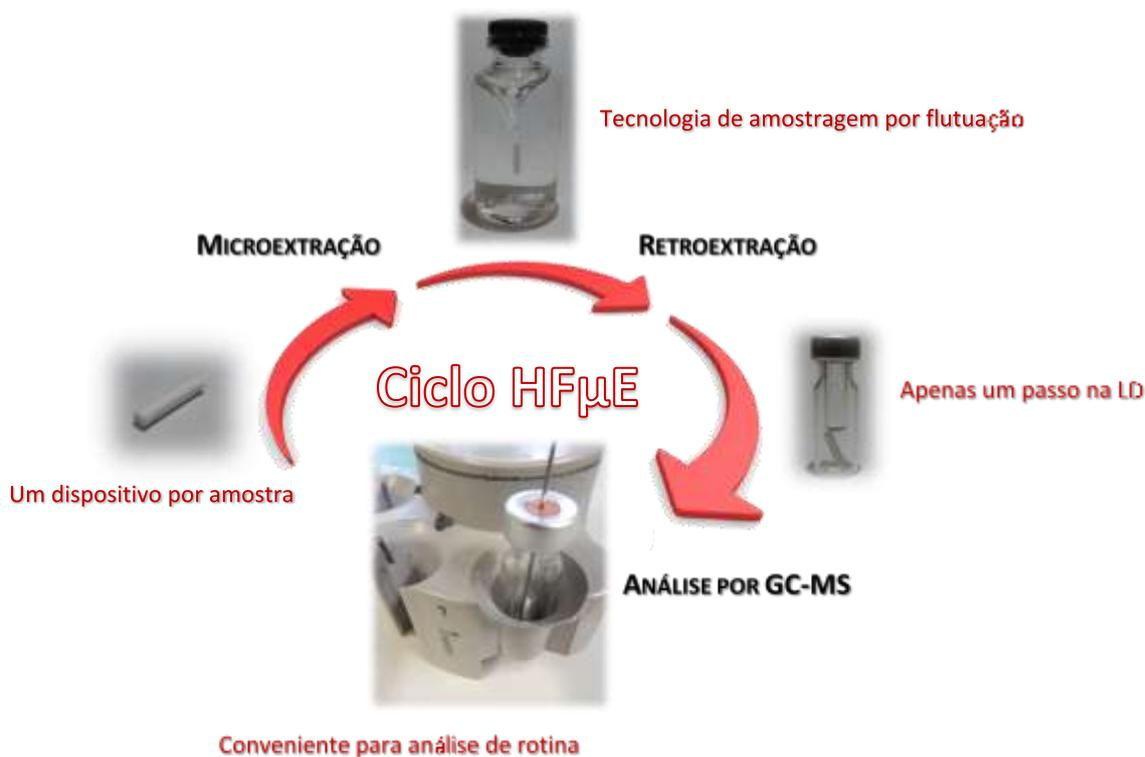
Figura 1.9 – Esquema relativo ao procedimento experimental proposto no ciclo HF $\mu$ E.
