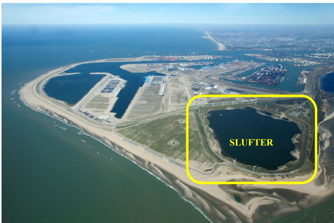
Figura 13 -. Slufter - Local para deposição confinada de material de dragagem contaminada - Fonte: Port of Rotterdam, 2017a adaptada pelo autor
