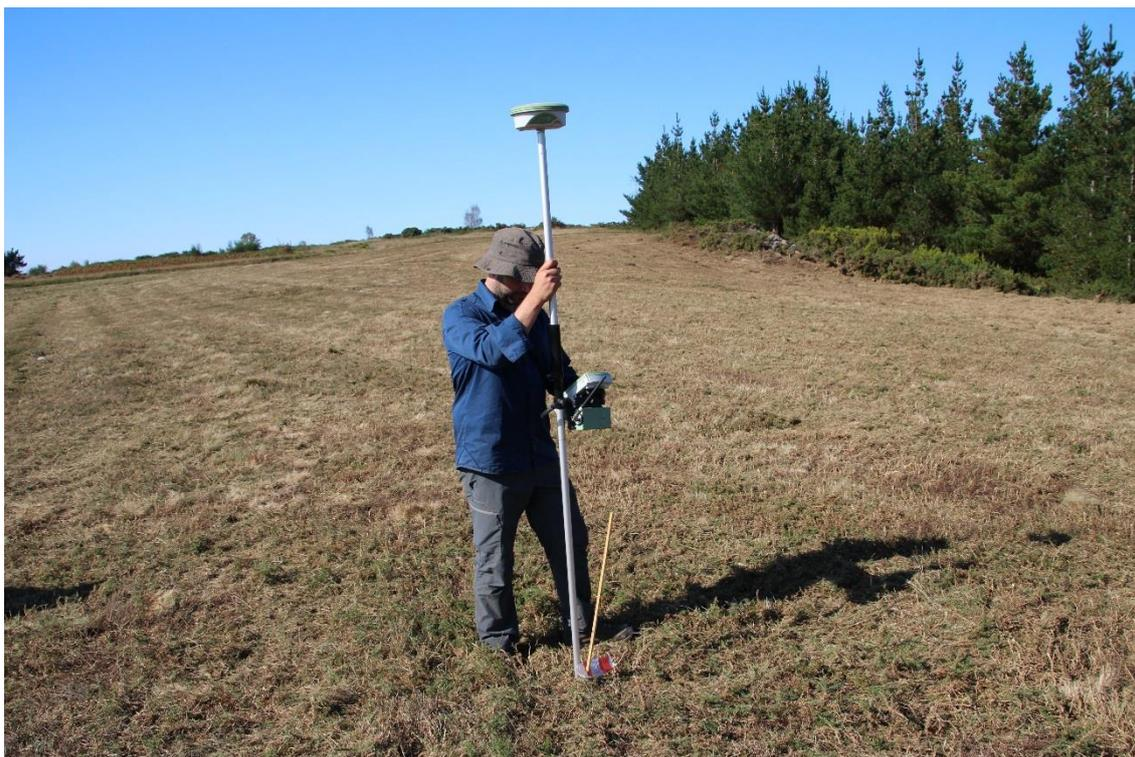
Figura 10. Proceso de toma de puntos con GPS RTK submétrico (A Fonsagrada, octubre de 2017).
