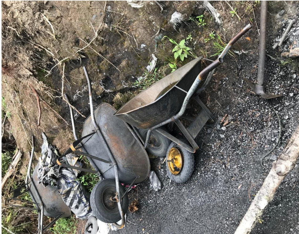
Figura 14: Carretillas Buggy deterioradas.
