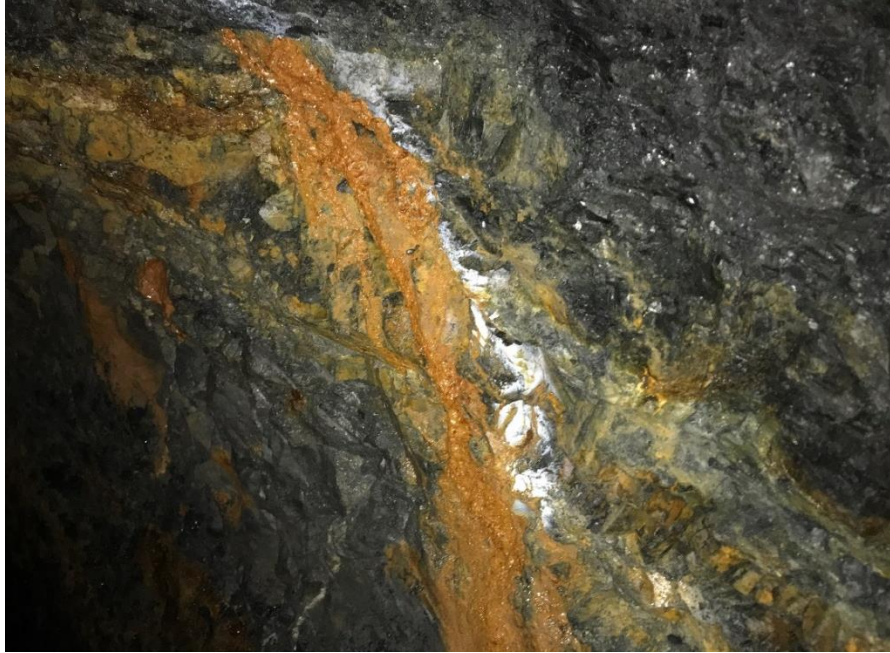
Figura 13: Presencia de óxidos en el macizo rocoso de las labores Séptima Maravilla II.
