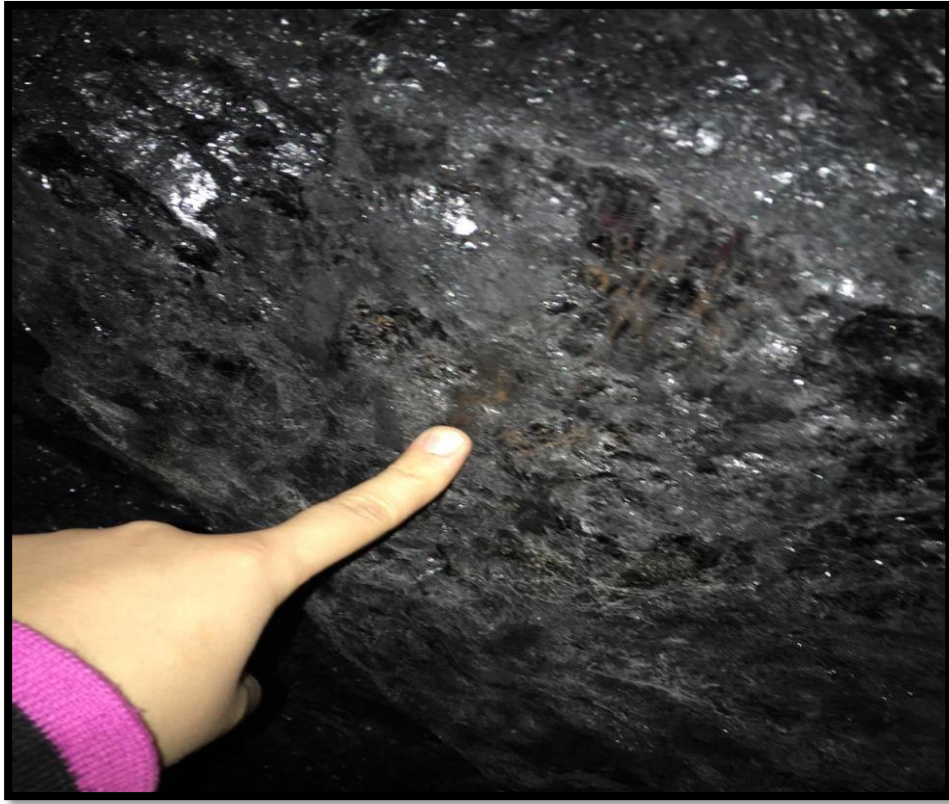
Figura 11: Rugosidad del macizo rocoso en las labores Séptima Maravilla II.
