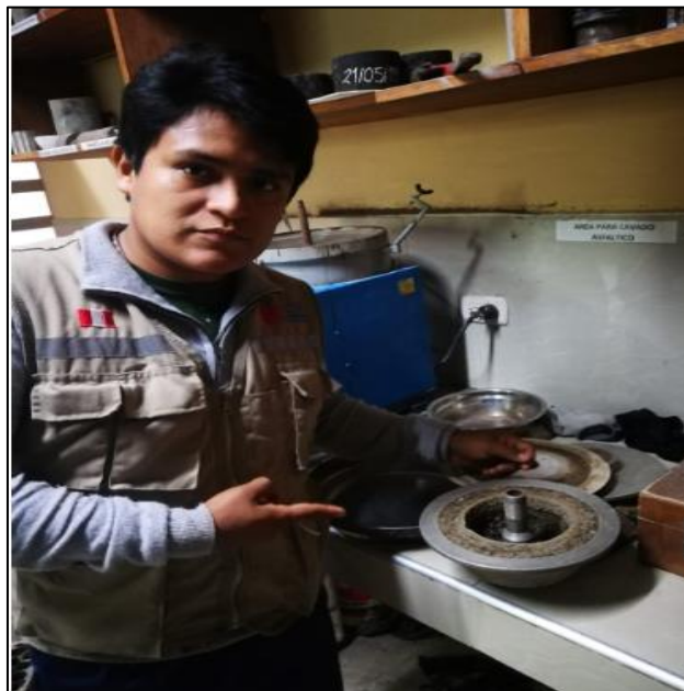
Fotografía N°21: Material luego de culminar la centrífuga de asfalto
