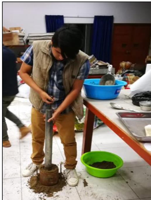
Fotografía N°14: Se apisona la muestra en molde de Próctor Modificado – C 02
