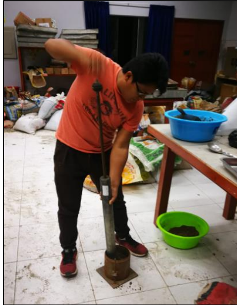
Fotografía N°13: Se realizó el ensayo de Próctor Modificado C 02
