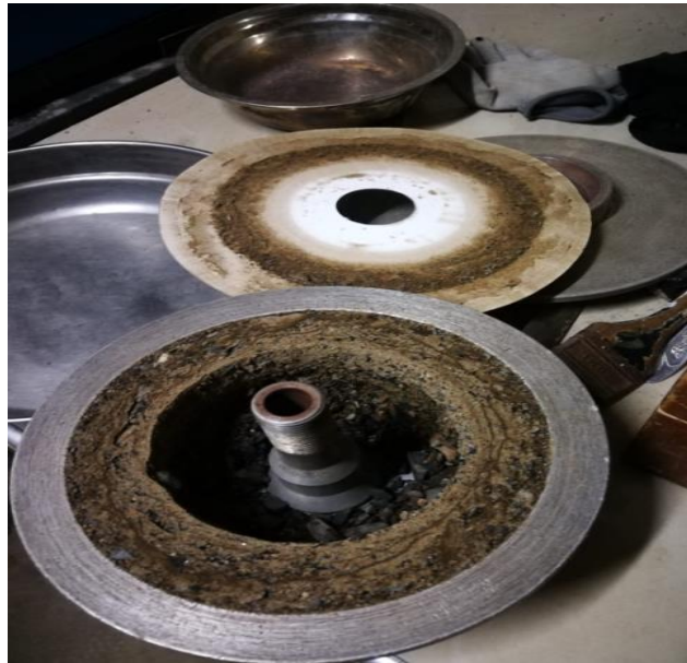
Fotografía N°20: Separando el filtro del material después de culminar el centrifugado
