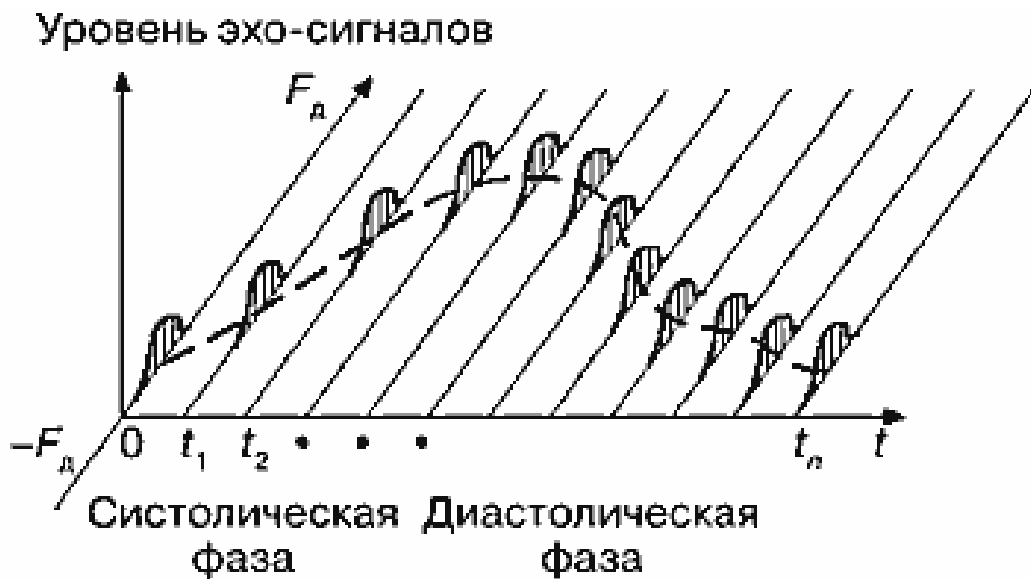
Рисунок 1.3 – Зміна спектра частот доплерівського зсуву в часі
