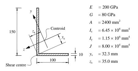
Fig. 5 Unequal angle section
