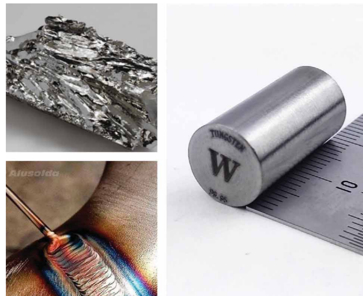
Figura 1: Tungsténio: metal com alta pureza extraído da volframite e com aplicação na soldadura TIG e nas lâmpadas de filamento.
