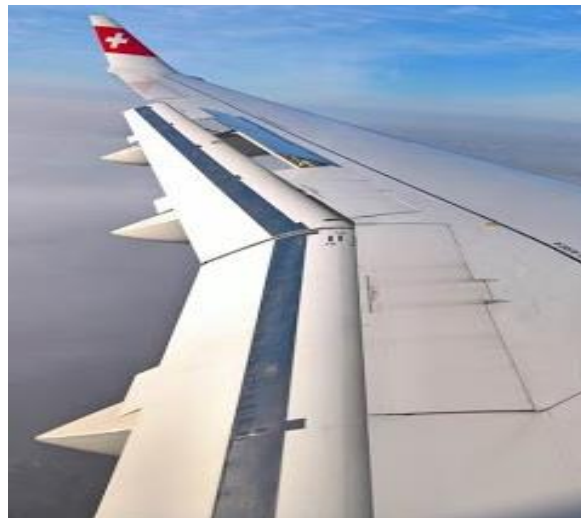
Figura 6.8. Dispositivos hipersustentadores en el ala de un avión comercial
