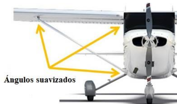
Figura 7.3. Elementos que originan resistencia de forma en una avioneta
