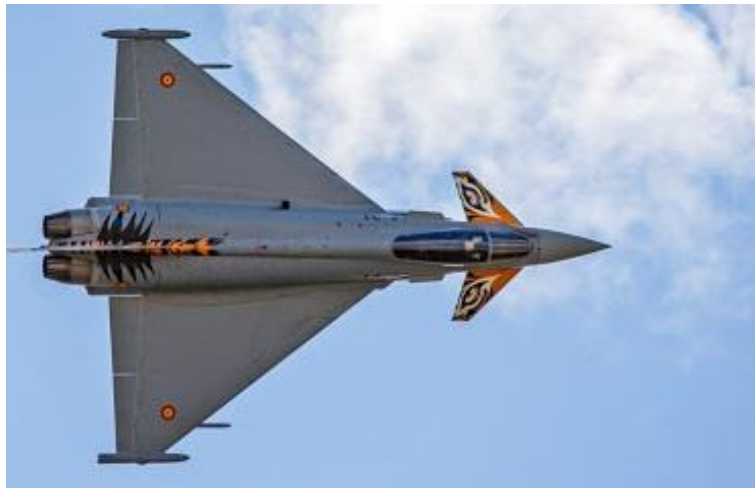
Figura 22.2. Avión de combate con ala delta truncada y canards
