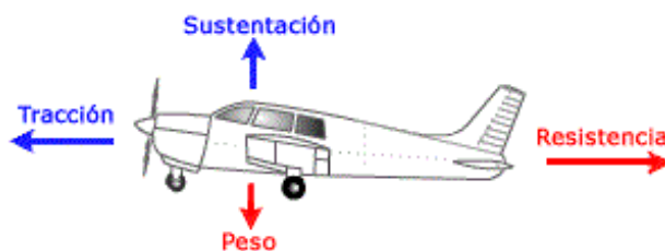
Figura 6.1. Fuerzas principales que actúan en una aeronave
