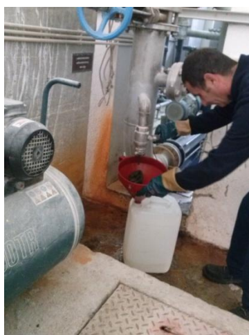
Figura 6.1 - Colheita da amostra de lama para o ensaio, pela purga do silo de lamas.
