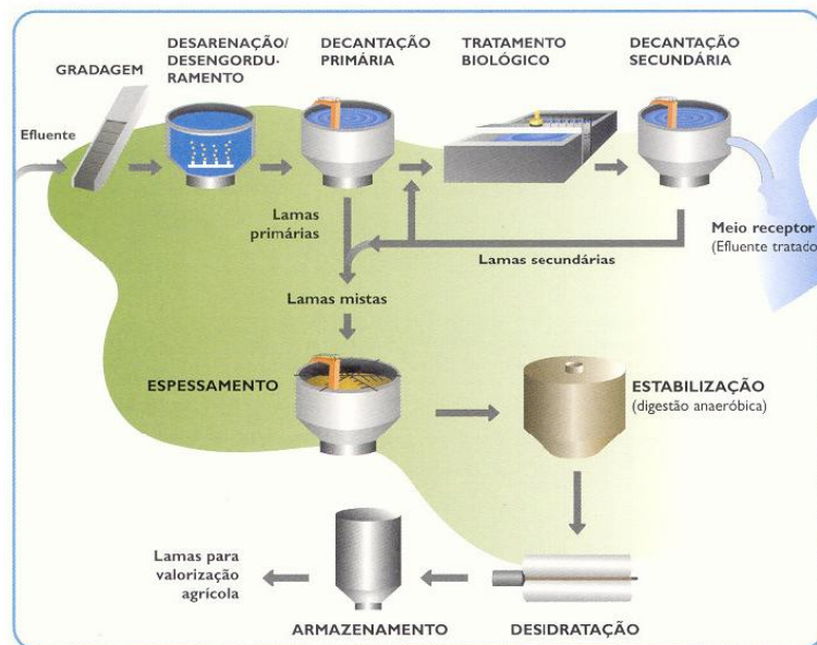
Figura 2.1 - Esquema geral de funcionamento de uma ETAR (Fonte: Soveral-Dias, 2004).
