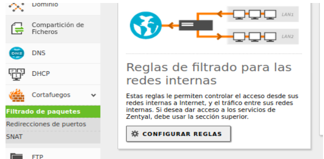
Figura 57. Reglas de filtrado para las redes internas
