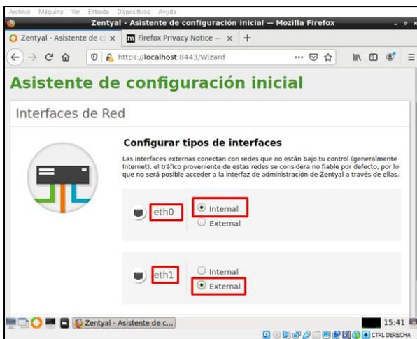
Figura 22. configuración de las interfaces de red.
