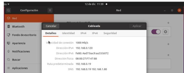
Figura 24: Validación de asignación de IP por medio de DHCP – Configuración de red
