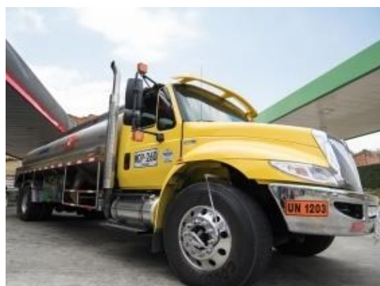
Figura 52. Camión rígido de dos ejes tipo cisterna en acero inoxidable
