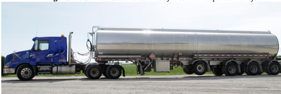
Figura 47. Camión Cisterna de tres ejes con remolque de tres ejes
