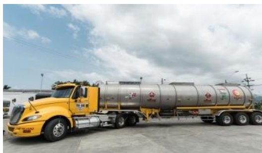
Figura 51. Camión Cisterna de tres ejes con semirremolque
