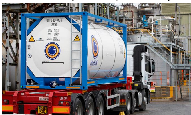
Figura 49. Camión isotanque de tres ejes con remolque de tres ejes
