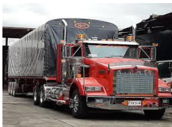
Figura 50. Tracto camión de tres ejes con semirremolques de tres ejes con estaca y carpa.
