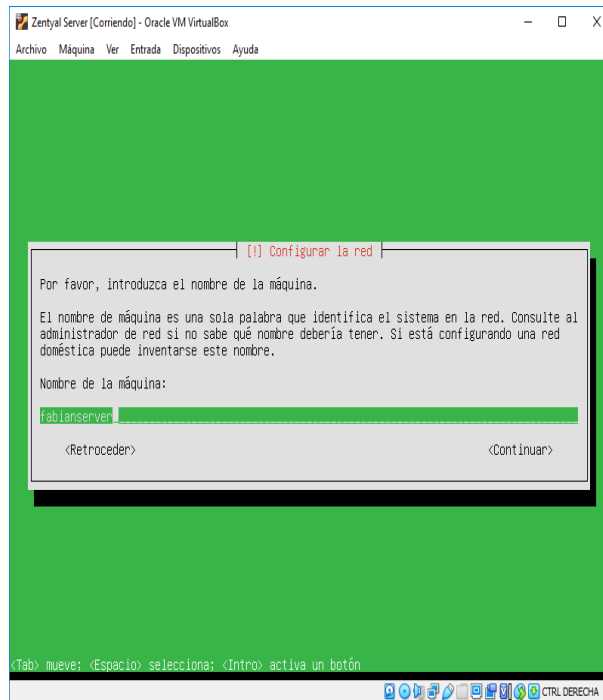
Figura 41. Instalación Zentyal Server
