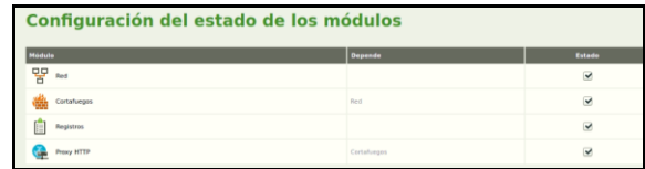
Figura 37. Instalación de módulos Proxy HTTP y Cortafuegos
