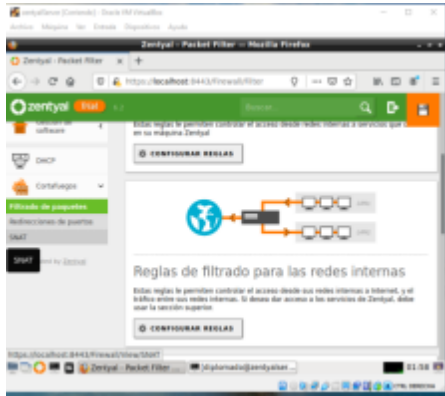
Imagen 26. Seleccionamos las Reglas de filtrado de redes internas.
