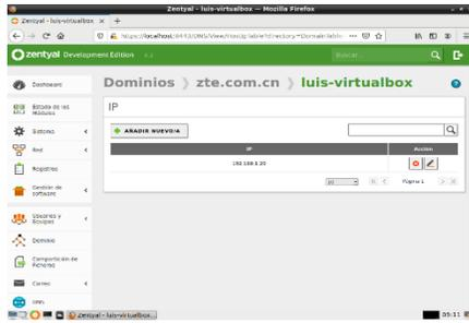
Figura 16: Adición de dirección ip del cliente.
