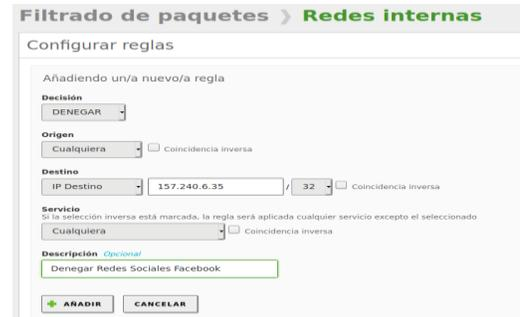
Figura 49: Configuración de reglas.
