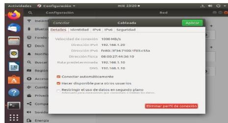
Figura 13: Confirmación de asignación de la IP del servidor Zentyal a la configuración del cliente
