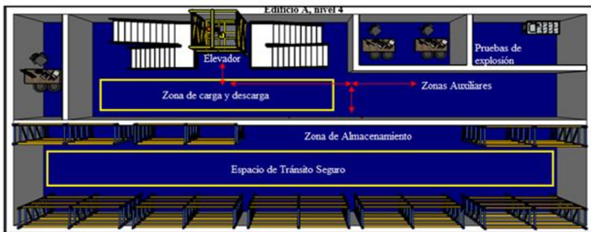
Figura 23. Planta de producción cuarto piso, Almacén de producto semielaborado. Cuarto piso de la planta de Soldexel donde se almacena producto semielaborado para realizar pruebas. Nota: Autoría Propia.
