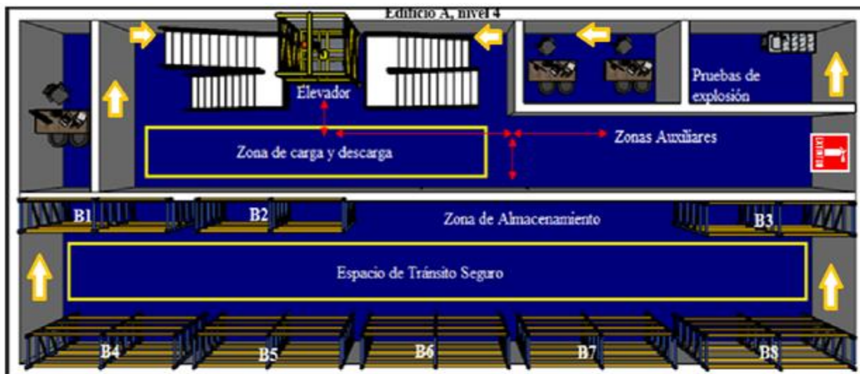
Figura 27. Planta de producción cuarto piso, Almacén de producto semielaborado. Plano actualizado con mejoras en etiquetado, zonas y salida de evacuación. Nota: Autoría propia.
