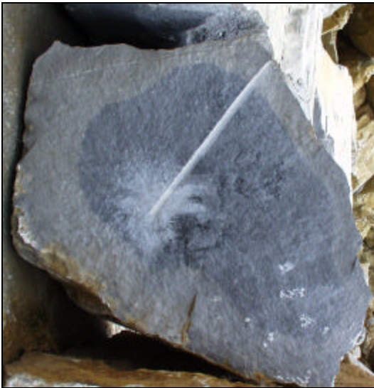
Foto 72 : Blok uit Trou des Chats met bruinere verkleuring aan de randen (foto V. CNUDE).
