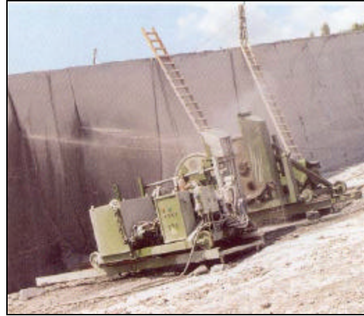
Foto 19: Het zagen met draad van de blokken in Carrières du Hainaut.
