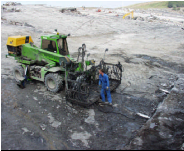
Foto 21: Hydraulische machine waarmee men de blokken splijt, Carrière du Clypot (foto V. CNUDE).
