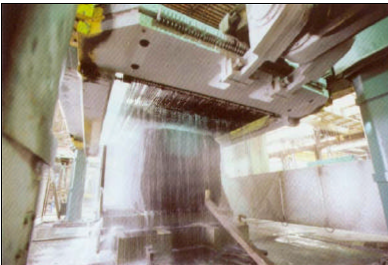
Foto 23: Raamzaag die dag en nacht de blokken verzagen (foto Carrières du Hainaut).
