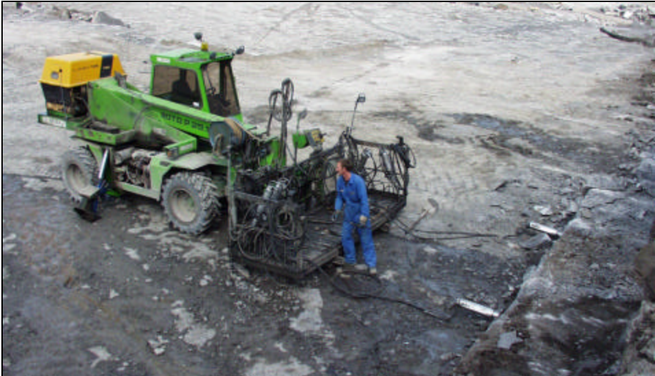
Foto 35: Deze hydraulische machine splijt de blokken in de groeve Clypot (foto V. CNUDDÉ).
