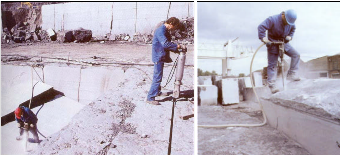
Foto 20: De "rocteur" met zijn hoek- en perforatiehamer zorgt voor het kanthouwen (foto's Carrières du Hainaut).
