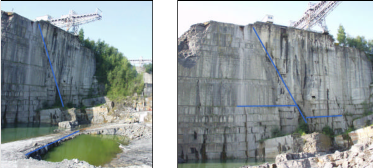
Foto 39: Het breukvlak in de groeve Gauthier-Wincqz met de verschuiving van de lagen (foto V. CNUDE).
