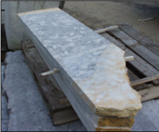
Foto 1: Verweringskorst nabij de rand van de platen (foto V. CNUDDÉ).
