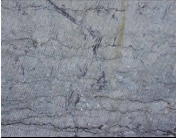
Foto 5: Stylolieten als zwarte lijnen in onderste deel van de Braye, groeve Gauthier-Wincqz (foto V. CNUDE).
