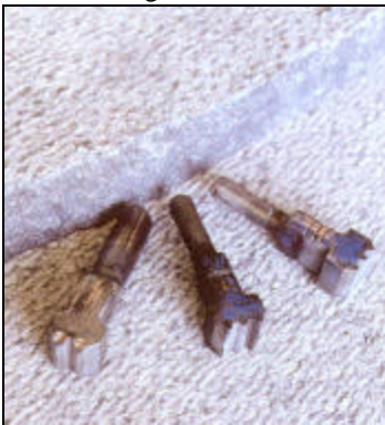
Foto 84: Blauwe hardsteen die de mechanische oude frijnslag onderging.
