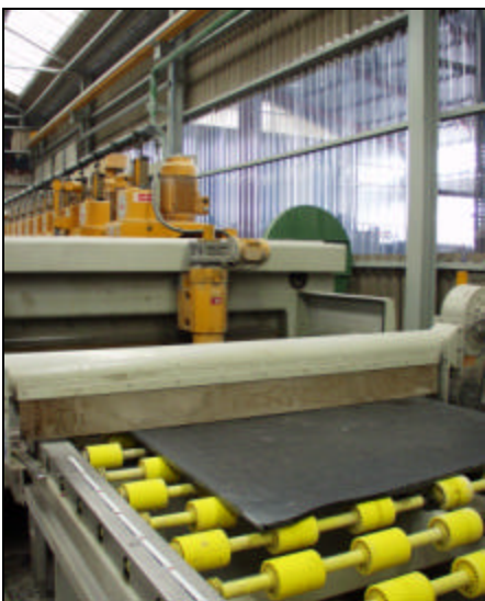
Foto 90: Machine in Carrière du Hainaut waarmee men de platen polijst.
