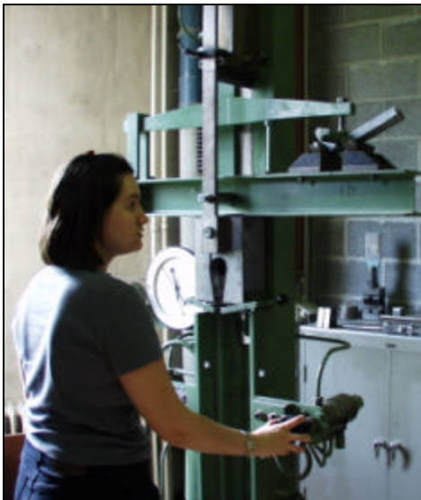
Foto 91: Toestel voor de bepaling van de buigtreksterkte.
