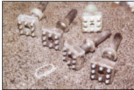
Foto 80: Mechanisch gehamerde blauwe hardsteen (links), bouchardeerhamers (rechts).
