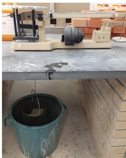
Figura 33 - Procedimento para o ensaio de massa volúmica
