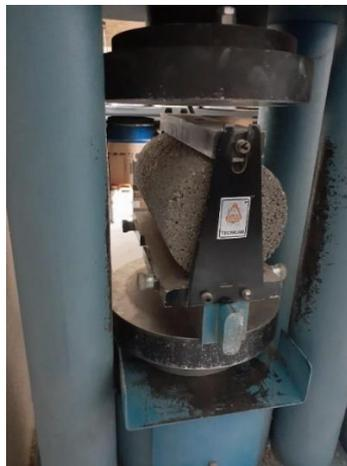
**Figura 37 - Ensaio de resistência à tração por compressão diametral**
