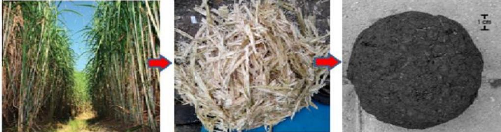
**Figura 8 - Cinza de bagaço de cana-de-açúcar**
