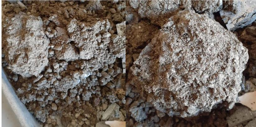
**Figura 29 - Provete com pouca coesão entre os materiais**
