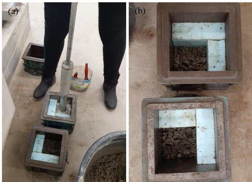
Figura 26 - (a) Compactação manual (b) Moldes metálicos com adaptação de XPS
