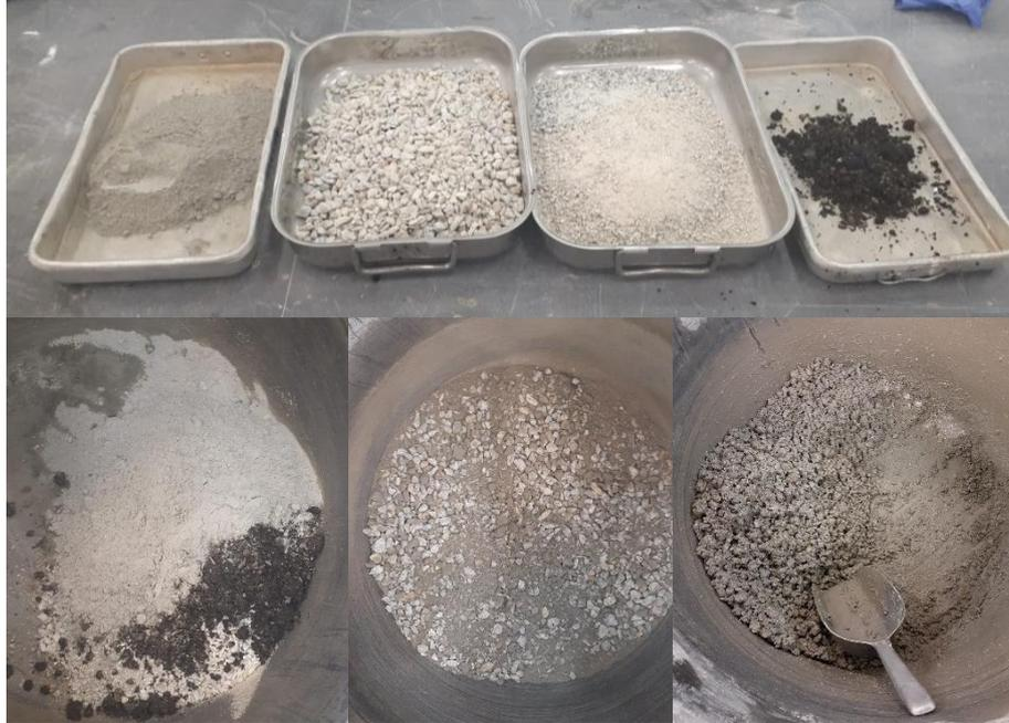
**Figura 28 - Processo de produção dos provetes com resíduo**
