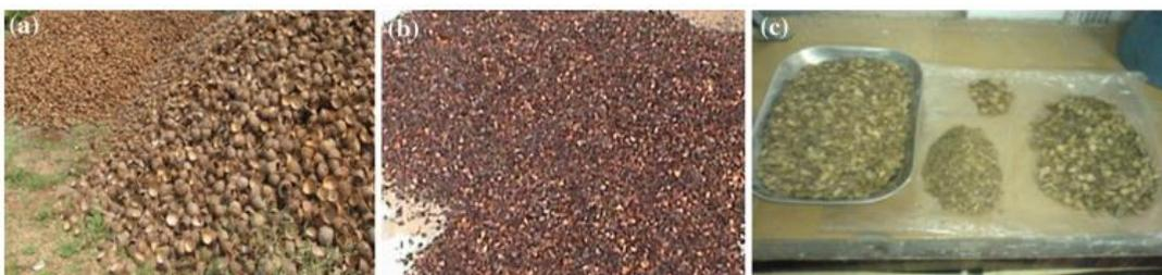
**Figura 7 – (a) Casca de coco natural (b) Casca de coco triturada (c) Partículas graduadas**
