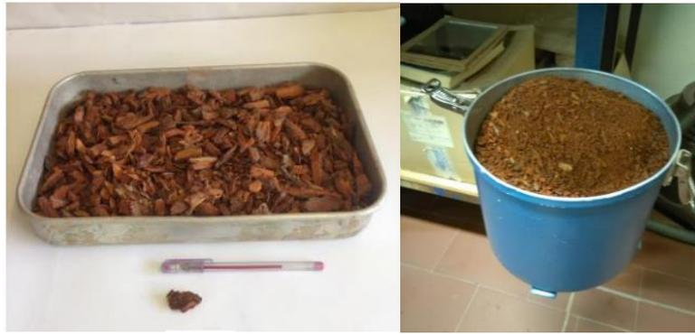
**Figura 5 - Granulado obtido com o triturador e com o moinho picador**
