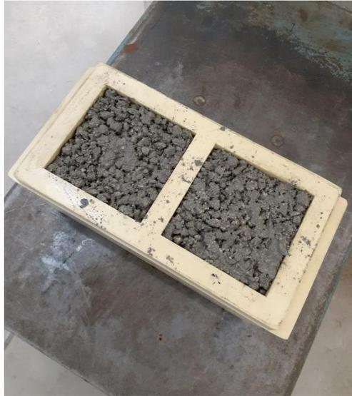
Figura 25 - Provetes produzidos em molde polimérico e em mesa vibratória
