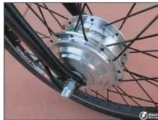
Figura 21: Motor de cubo [24]
