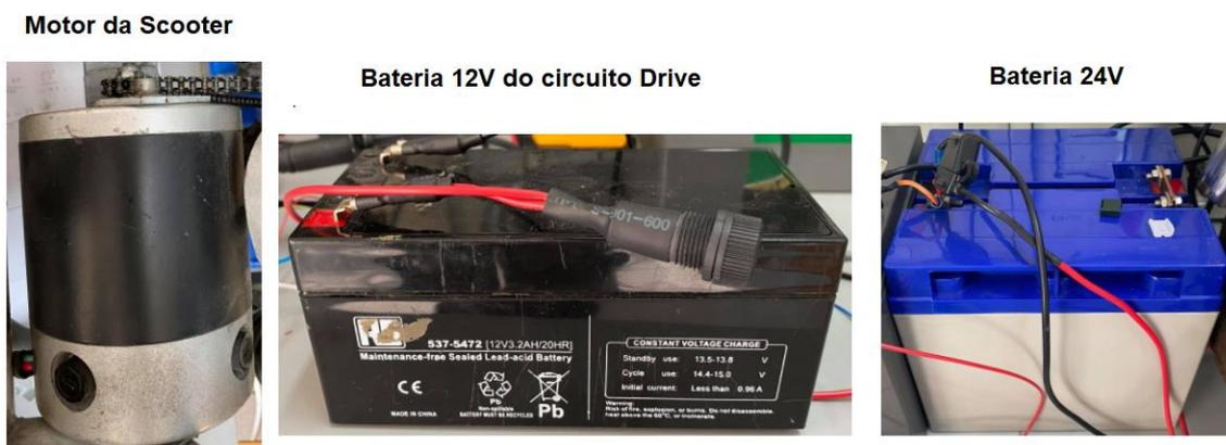
Figura 69: Componentes da scooter
