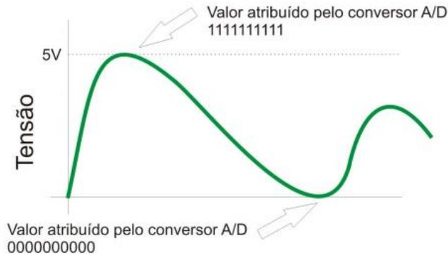
Figura 43: Sinal de Tensão compatível com o conversor A/D [10]
