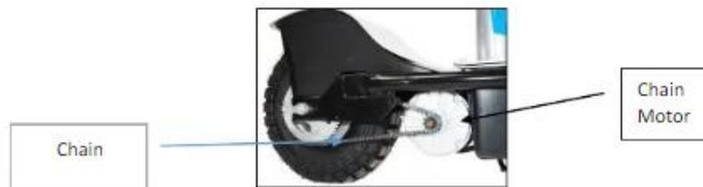
*Figura 23: Motor de corrente instalado em uma Scooter [24]*
