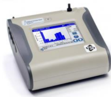
Figura 5 – Analizador granulométrico de partículas da marca TSI, modelo 3330 (OPS-3330). Fonte: TSI, 2012.
