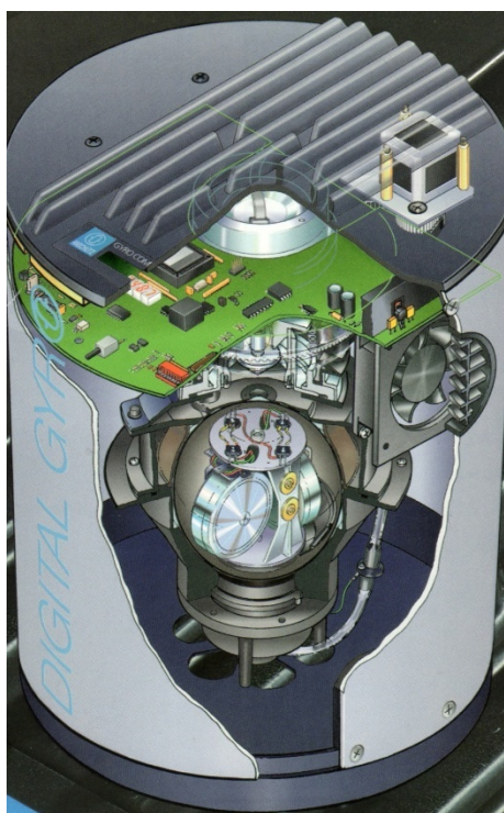
Рис.1.7. Конструкція гірокомпасу Standard 20 (Anschütz & Co.).
