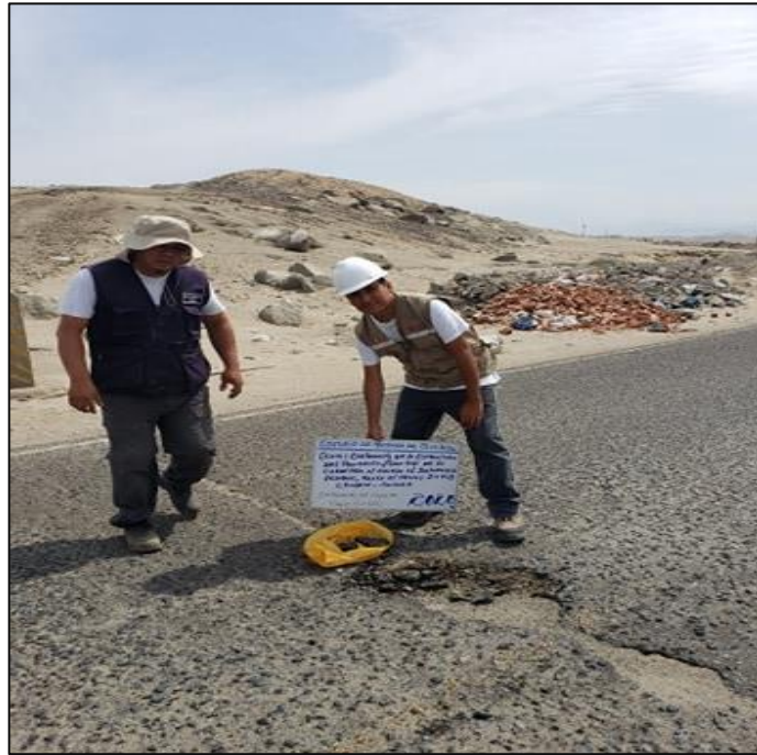
Extracción de muestra para lavado asfáltico
