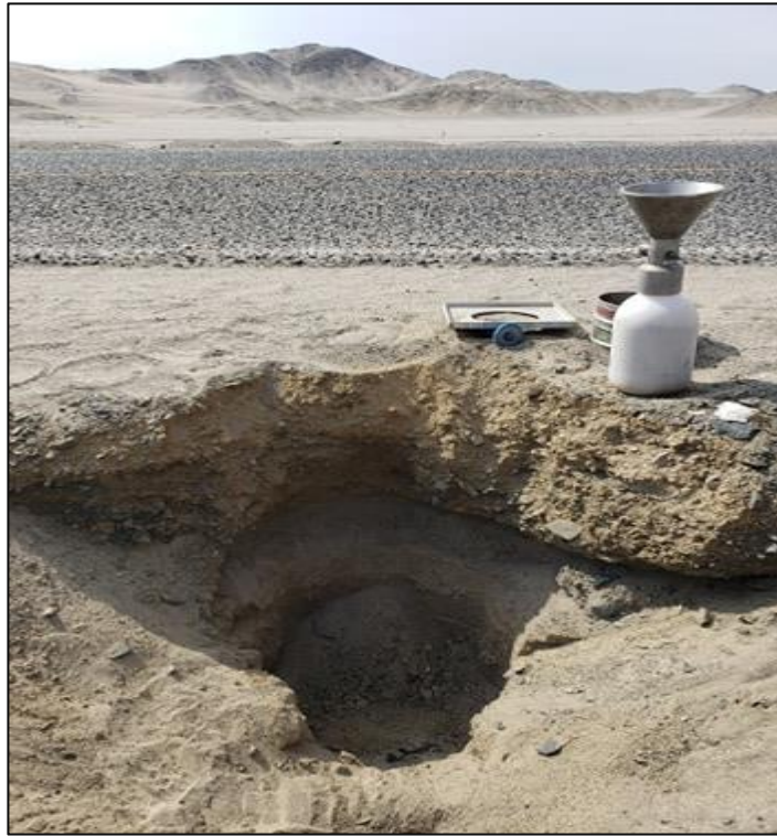
Se observa el perfil estratigráfico de la calicata 3 de la carretera AN-930
