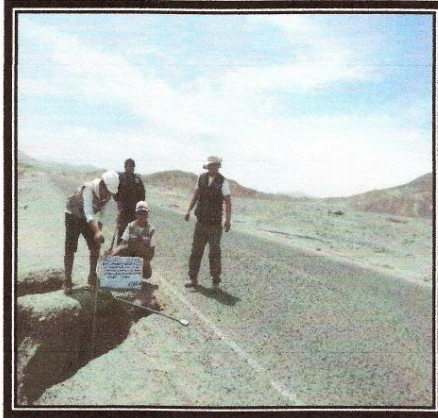
FOTOS N° 09,10: Excavación manual de Calicata N° 03
