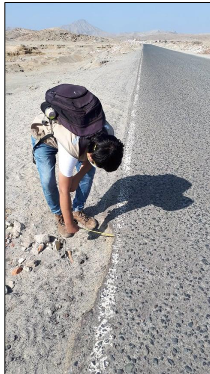
Medición de cada una de las patologías encontradas según indica el manual PCI para la carretera AN-930
