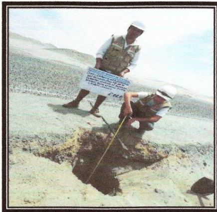
FOTOS N° 15,16: Excavación manual de Calicata N° 04
