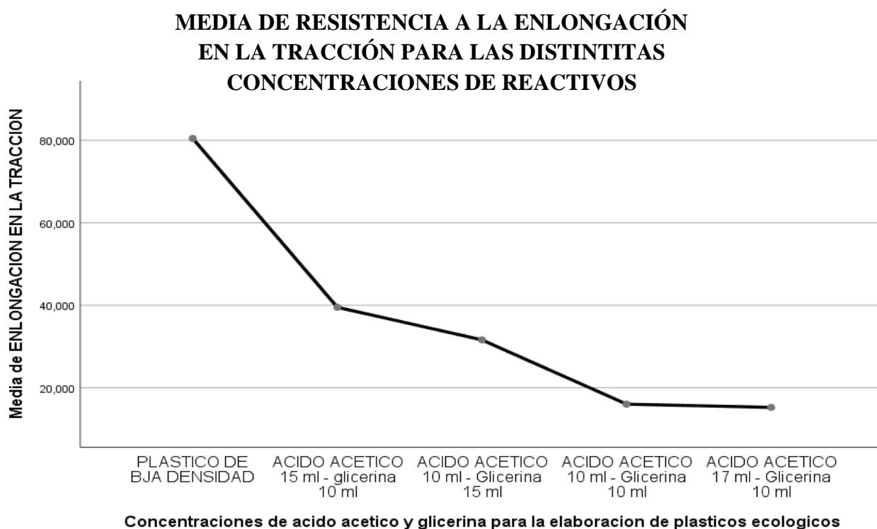
Figura 8: Comparación de medias para la prueba de Elongación en la tracción de los Plásticos Ecológicos
