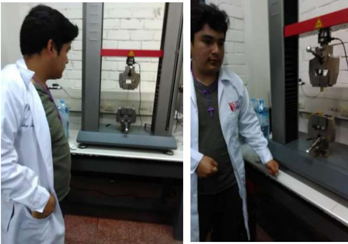
Figura 26. Plástico Ecológico obtenido del almidón de la cáscara de plátano sometido a ensayos de tracción, elongación. Laboratorio LABICER-UNI.
