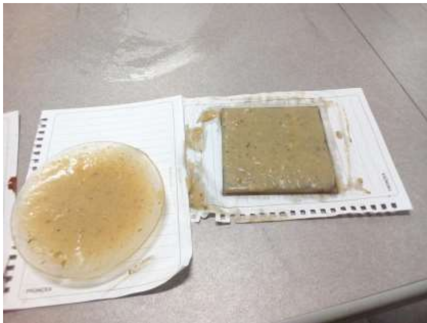
Figura 25. Lámina de plástico ecológico obtenido después de la cocción, lo cual se deja reposar a temperatura ambiente.
