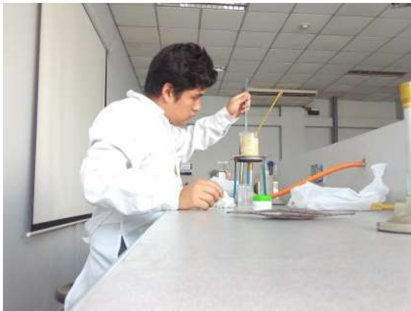
Figura 23. Elaboración de distintas muestras de los Plásticos Ecológicos incorporación de la glicerina y ácido acético según la dosis de cada muestra.
