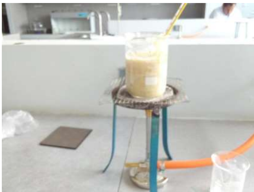
Figura 24. Elaboración del Plástico Ecológico, el cual es sometido a temperatura con la ayuda de un mechero Bucen.
