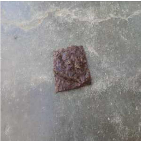
Ruptura de la muestra en agua
