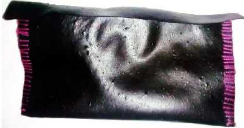
*Figura 03* : Modelo de recipiente a escala pequeña con el bioplástico obtenido
