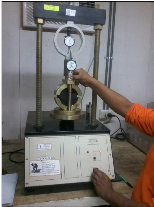
Foto 12: Laboratorio CD Projects Ensayo Marshall
