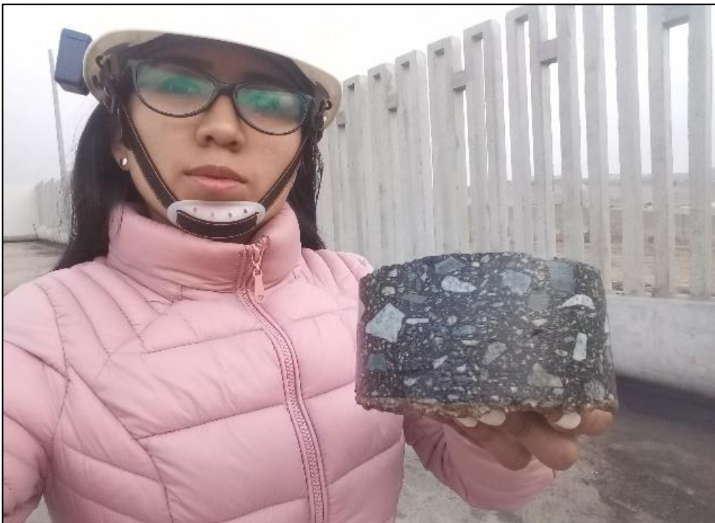
Foto 24: Control de proceso. Briqueta de mezcla asfáltica convencional compactada
