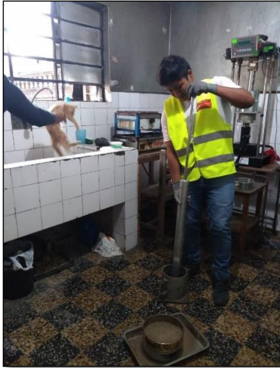
Foto 3: Laboratorio CD Projects. Compactación- Proctor
