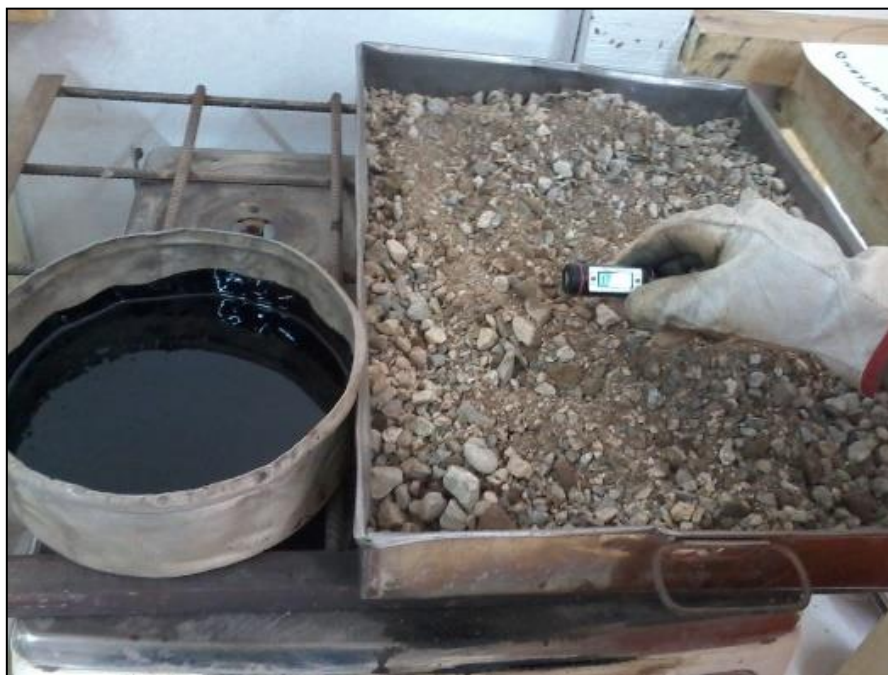
Foto 8: Laboratorio CD Projects. Producción Briquetas de Asfalto
