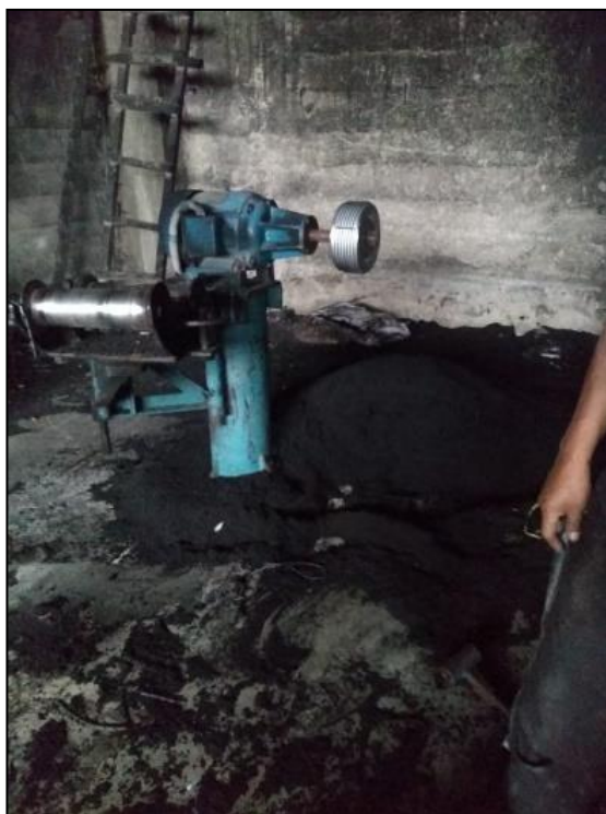
Foto 5: Extracción de caucho en Reacauchadora
