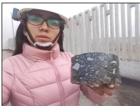
Figura 1. Briqueta con agregados mineral en una probeta de mezcla compactada
